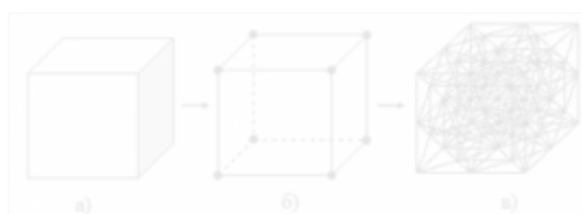
Рис. 1.21. Етапи дискретизації області : а) об'єкт; б) каркасна модель; в) дискретна модель.
